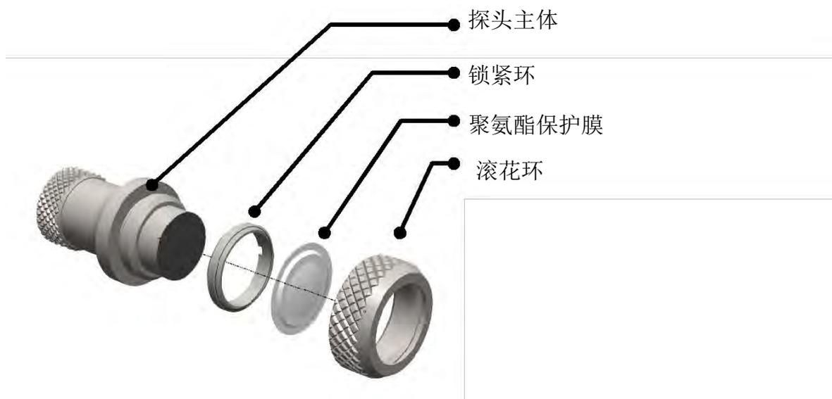
Fig 7. 单晶探头保护膜安装零件
