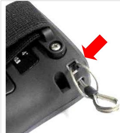
将线环安装到测厚仪本体上，只需将线环穿过仪表上的孔，然后连到另一端。
