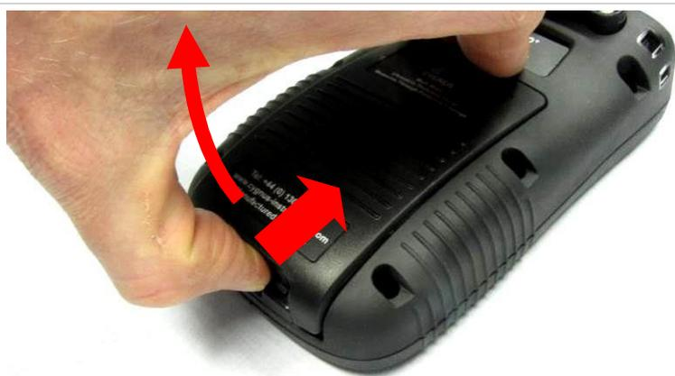
按下电池盖子的底部，松开固定夹，然后提起电池盖子。
